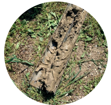
Bodenproben werden in ein aufklappbares Kunststoffrohr einvibriert
