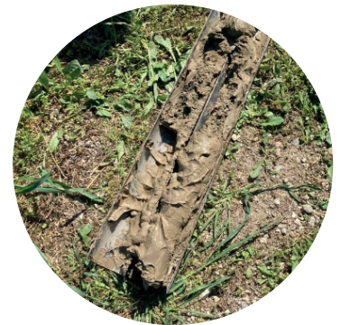
Bodenproben werden in ein aufklappbares Kunststoffrohr einvibriert
